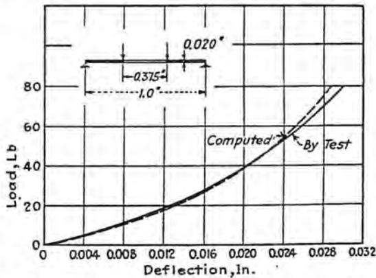
FIG. 4 LOAD-DEFLECTION CURVE FOR AN INITIALLY FLAT DISK SPRING
