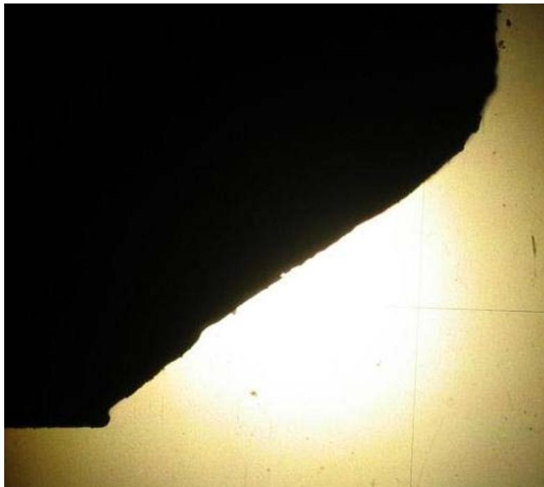
Figure 3.19 10x Magnification of Mast Arm Weld Before UIT
