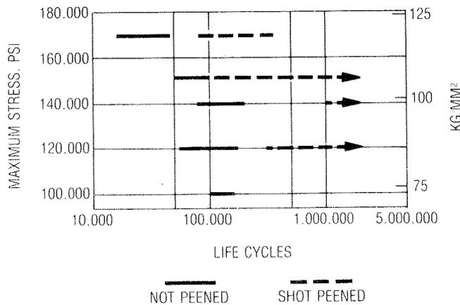
Fig. 5. LIFE TEST RESULTS ON AUTOMOTIVE LEAF SPRINGS
