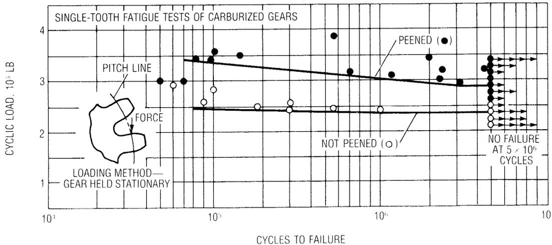
Fig. 6. CARBURIZED PLANET GEARS (4.8 DP WITH 1.4-IN. FACES). FROM THE SAME 4118 STOCK. SHOWED INCREASED LOAD CAPACITY WHEN SHOT PEENED
